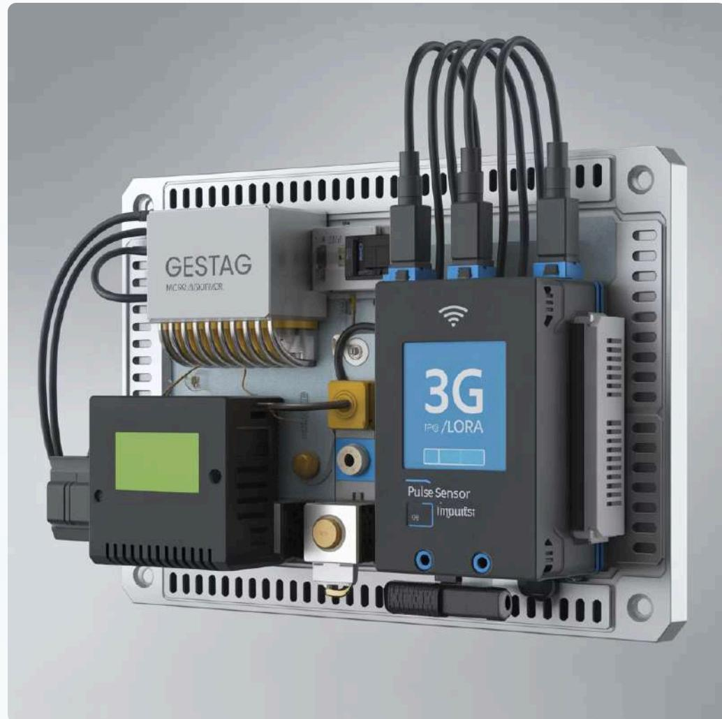
O módulo GESTAG possui microcontrolador de baixo consumo, módulo IoT multi-rede (LoRa/NB-IoT/Cat-M1) e 8 entradas de pulso, com suporte a LoRaWAN, Ethernet/Wi-Fi e MQTT.
